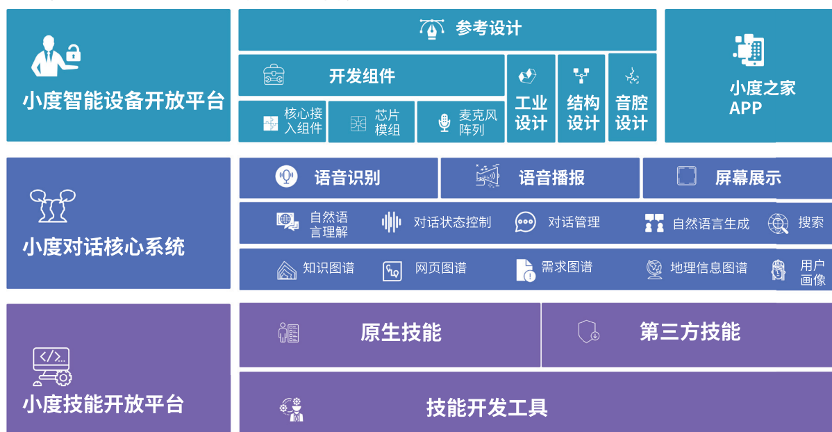
图6 百度DuerOS对话式人工智能技术架构
